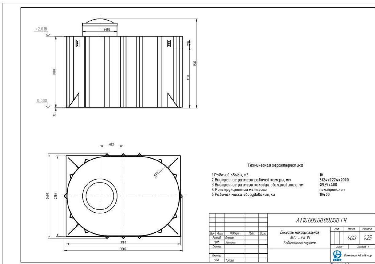
Данный чертеж носит ознакомительный характер, предоставлен для формирования общего понимания объема работ и количества расходных материалов. Производитель постоянно совершенствует продукцию, уточняйте размеры изделий перед заказом.
