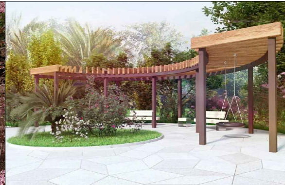
Поз.6 Пергола Высота 3000мм Ширина 5750мм Длина 12200мм Фундамент выполнить 0,6x0,6м, глубиной 1,2м из бетона кл. В15 F100 W6. Расход бетона – 4,32м 3
