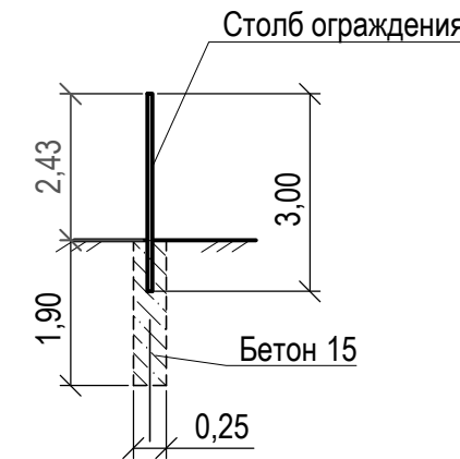
Схема установки столбов ограждения Optima 3D
